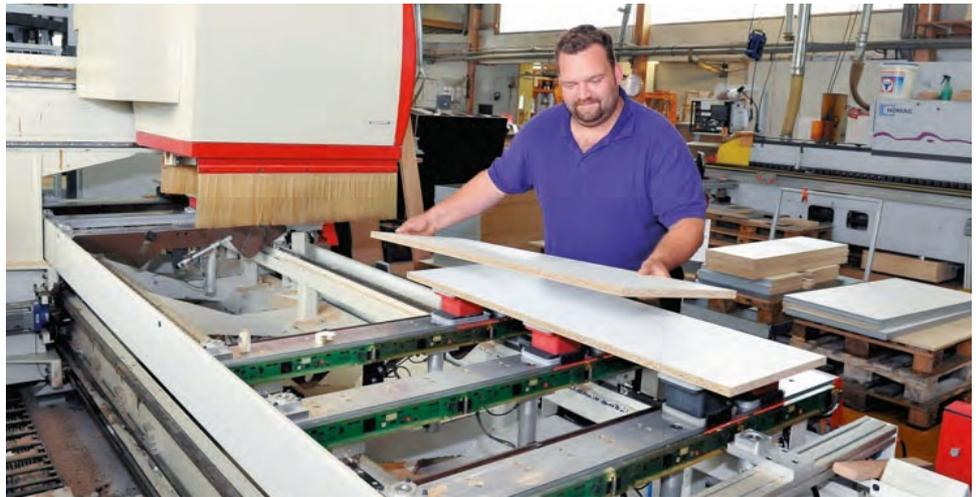
*Tobias Rausch am Bearbeitungszentrum: Hier werden Spanplatten maßgenau maschinell in Form gefräst. Die Spanplatten werden auf Vakuumsaugen aufgelegt, bevor sie bearbeitet werden.*
